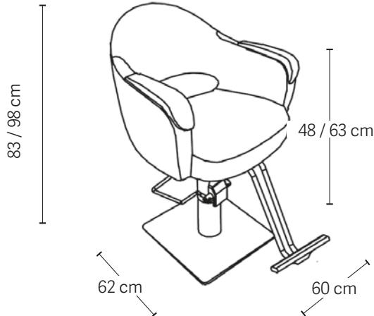
Silla de peluquería con diseño moderno que combina líneas curvas en color negro con acabados en plata. Pensada para dar la máxima comodidad: con bomba hidráulica para subir y bajar el asiento y combinable con 3 pies y con la opción de reposapiés.
